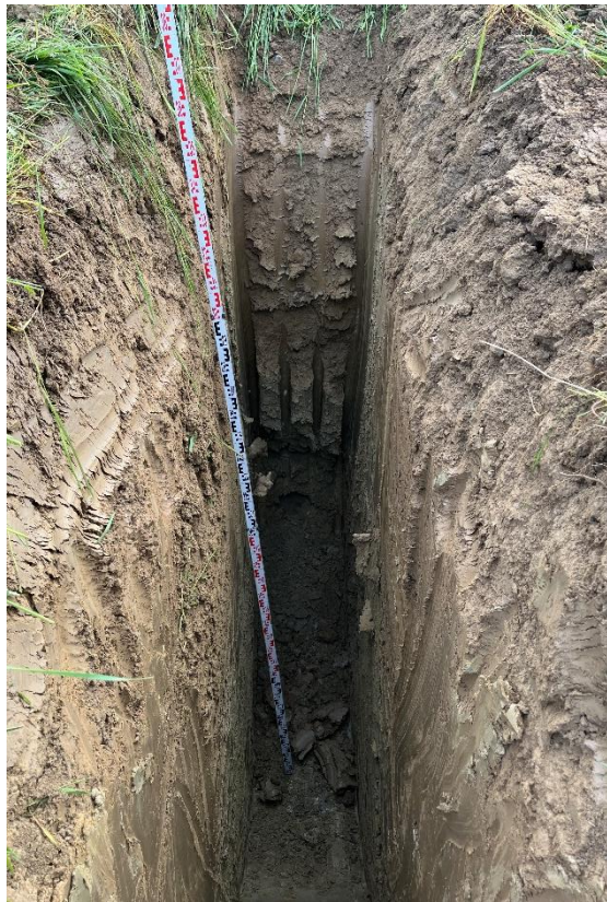
Tranchée de reconnaissance à la pelle mécanique T7446-01
