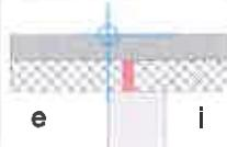
e i                                                                                                                                                             | Console de dalle isolante avec isolation de raccord 6 cm                 | <input type="checkbox"/> 0.30            | --                                              | <input type="checkbox"/> 0.25                                      | <input type="checkbox"/> 0.25 <input type="checkbox"/> 0.25        |
