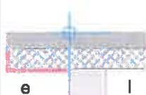
e i                                                                                                                                                           | Porte-à-faux 0.5 m, isolation 4 cm                                       | <input type="checkbox"/> 0.25            | --                                              | <input type="checkbox"/> <b>0.35</b> <input type="checkbox"/> 0.40 | <input type="checkbox"/> <b>0.40</b> <input type="checkbox"/> 0.25 |
